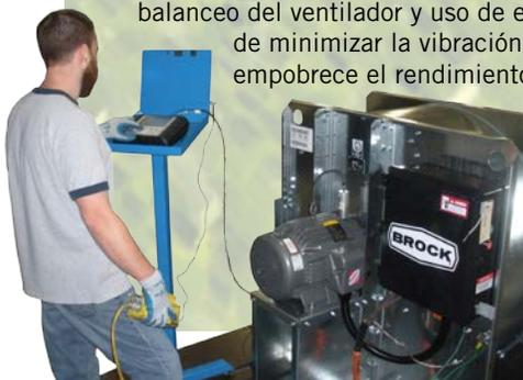
Los ventiladores centrífugos serie GUARDIAN® de Brock cuentan con un **bastidor de acero** galvanizado reforzado, calibre 12 que proporciona larga vida útil del ventilador. Los **motores** totalmente encerrados, enfriados por ventilador (TEFC) son el estándar.
