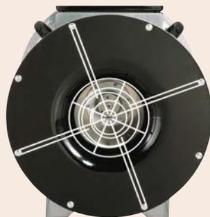
El innovador **orificio de entrada de aire** del ventilador ayuda a mejorar el flujo de aire a la rueda centrífuga para mejorar el rendimiento del ventilador. El diseño único del **deflector** dirige el aire hacia la rueda centrífuga para proporcionar el funcionamiento suave y eficiente del ventilador. La cobertura de PVC de 10 milipulgadas en la **rejilla de seguridad** proporciona resistencia superior a la corrosión.
